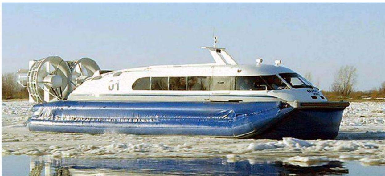
Рисунок 1 – Судно на воздушной подушке «Марс-2000»
