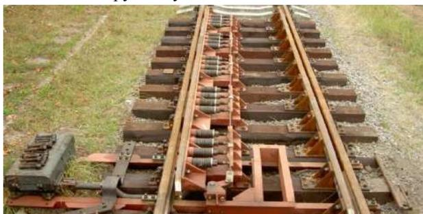
Рисунок 4 – Общий вид балочного заграждающего устройства БЗУ-ДУ
