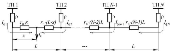
Рисунок 2 – Схема замещения расчетного однопутного участка
