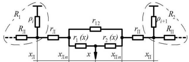
Рисунок 10 – Обобщенная схема замещения двухпутного участка тяговой сети
