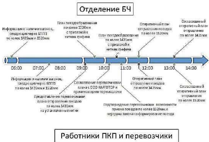
Рисунок 1 – Схема оперативного планирования перевозок через БППП по колее 1435 и 1520 мм
