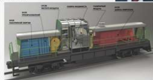
Рисунок 2 – Конструкция тепловоза ТЭМ9Н «SinaraHybrid»
