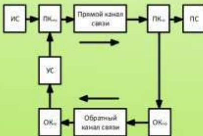
Рис.1. Упрощенная структурная схема системы передачи данных с Информационной обратной связью и ожиданием ИОС-Ож
