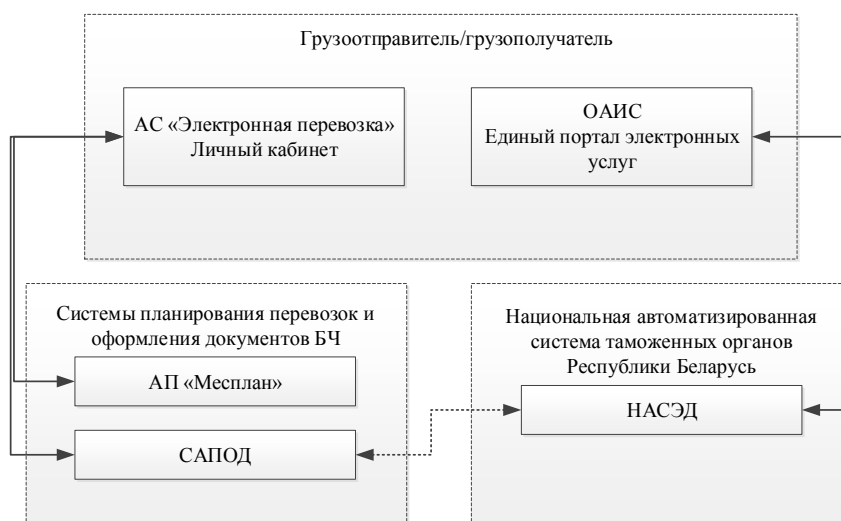
Рисунок 1 – Организация взаимодействия грузоотправителей/грузополучателей с железнодорожным перевозчиком и таможенными органами
