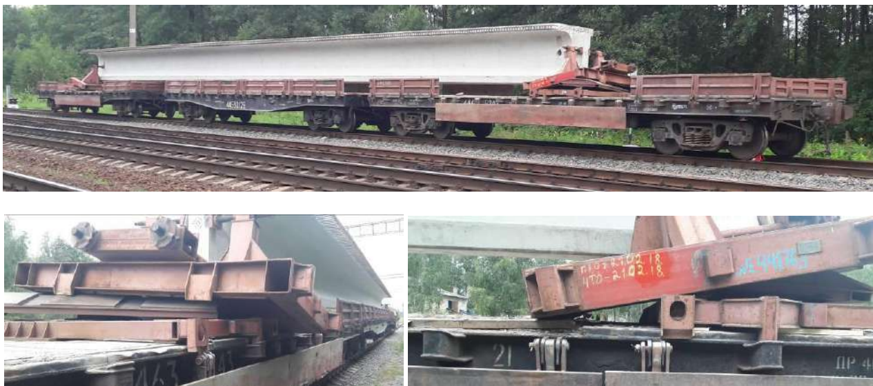
Рисунок 1– Последствия нарушений при эксплуатации турникетов грузоотправителем
