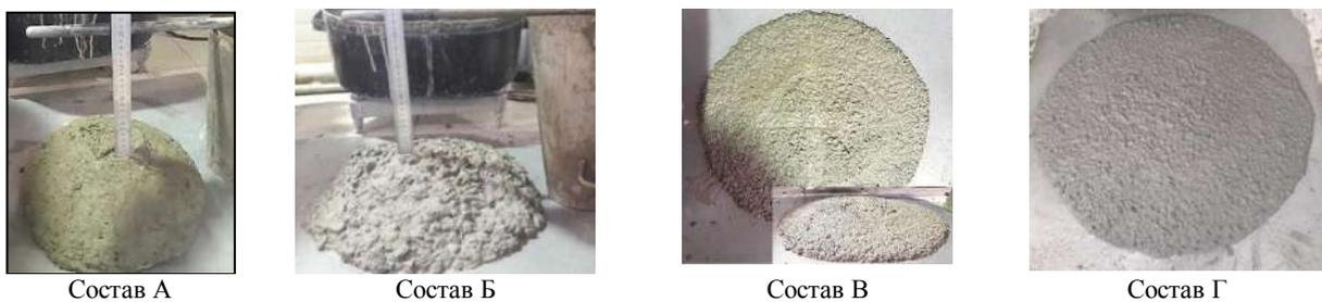
Рисунок 4 – Бетонная смесь с полимерной фиброй волнистого профиля
