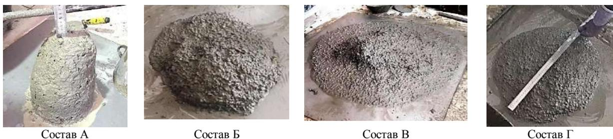
Рисунок 5 – Бетонная смесь со стальной фиброй волнистого профиля
