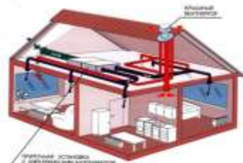
Рисунок 2 – Механическая система вентиляции
