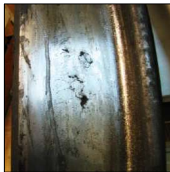
Рисунок 5 – Поверхность катания железнодорожного колеса после изнашивания
