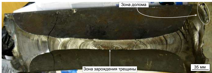
Рисунок 6 – Поверхность усталостного разрушения отколовшегося фрагмента колеса
