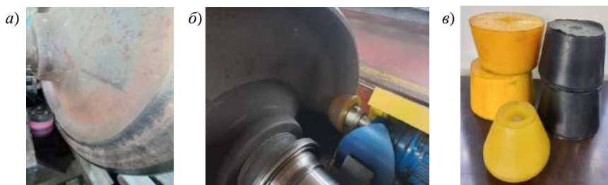
Рисунок 1 – Приводные ролики стенда УДП-2001 и СУДКП (СДВК): а – фрикционный ролик вращения КП с внутренней стороны обода колеса на вибродиагностическом стенде УДП-2001; б – фрикционный ролик вращения КП с внешней стороны обода колеса на стенде ультразвуковой дефектоскопии колесных пар СУДКП (СДВК); в – новые фрикционные ролики из резины и полиуретана для стендов СУДКП и УДП-2001
