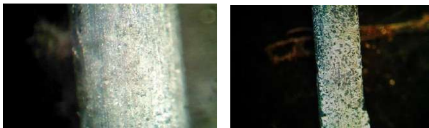
Рисунок 3 – Арматура после испытания, извлеченная из образцов № 2904-1 и № 2904-2. Увеличено: левый снимок в 48 раз, правый в 24 раза
