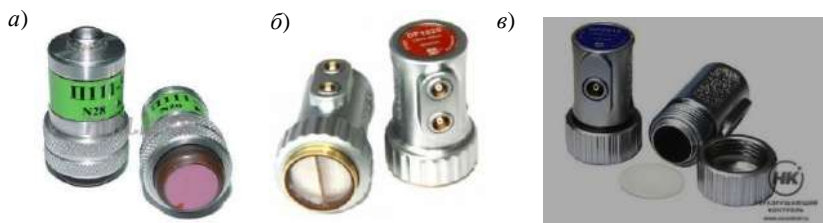
Рисунок 2 – Пьезоэлектрические преобразователи с протекторами из различных материалов для ультразвуковых дефектоскопов:
