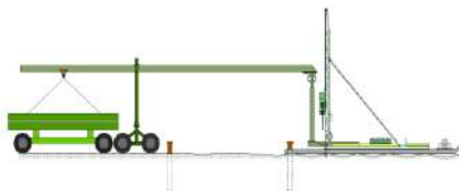
Рисунок 1 – Схема тележки с пролетным строением
