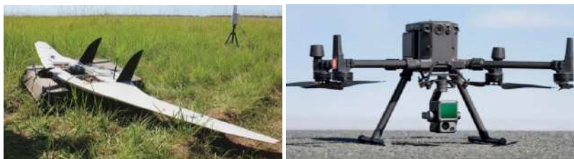
Рисунок 2 – Дроны, используемые для мониторинга состояния автомобильных дорог
