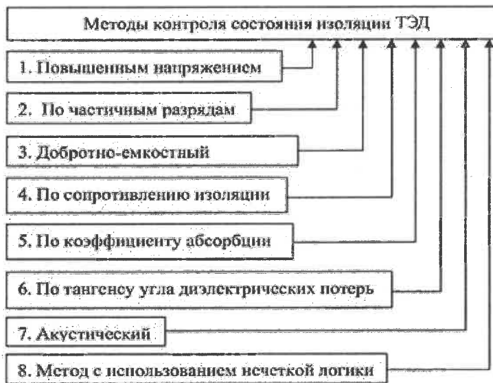
Рисунок 1 – Методы контроля изоляции ТЭД.
