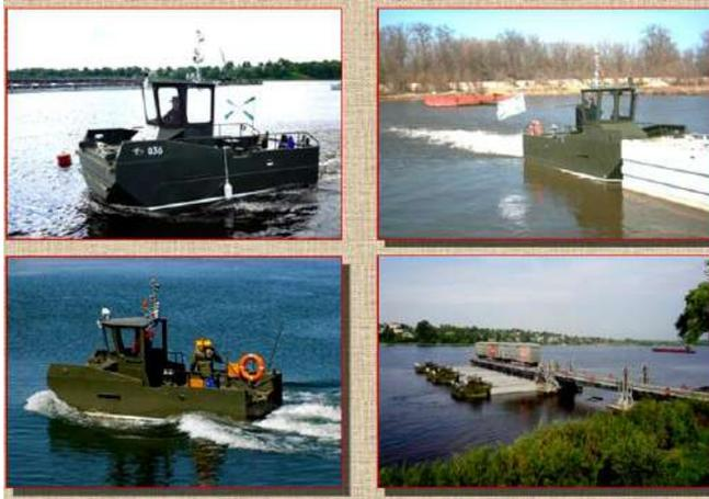
Рисунок 17 – Плавающий самоходный понтон (толкач) ПСТ-1
