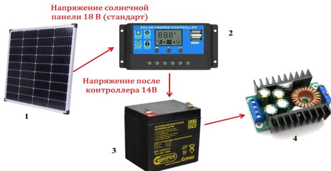
Рисунок 2 – Схема зарядного устройства с промежуточным накопителем:
