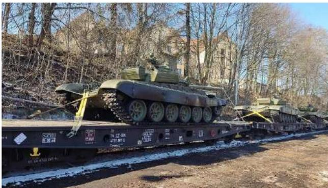
Рисунок 3 – Использование ремней при перевозке гусеничной техники
