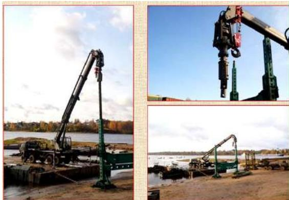
Рисунок 21 – Установка для завинчивания свай УЗС-85
