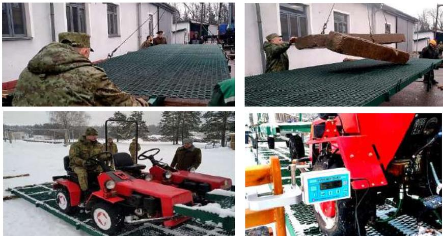
Рисунок 2 – Натурные испытания малогабаритных мостов в полевых условиях
