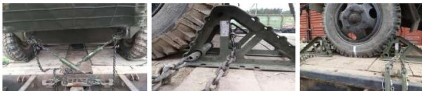
Рисунок 5 – Крепление техники при помощи МККТ Л1
