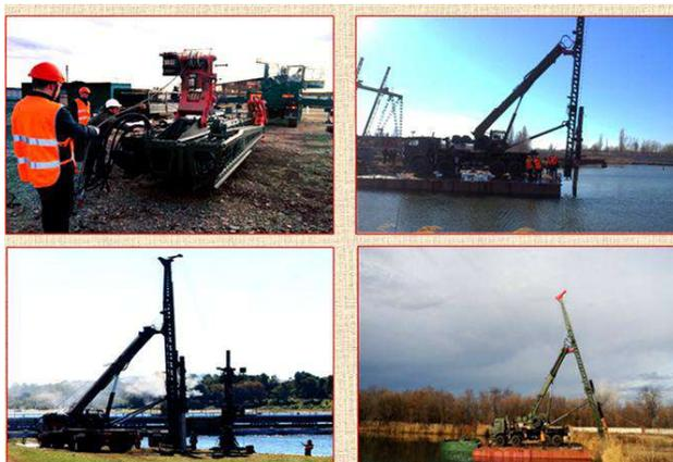
Рисунок 15 – Универсальный сваебойный агрегат УСА-2М
