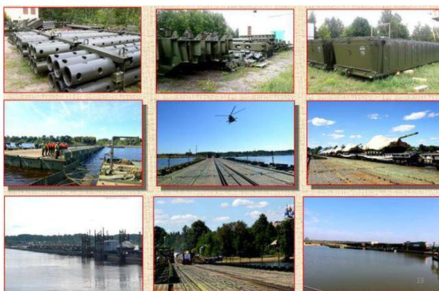
Рисунок 13 – Наплавной унифицированный железнодорожный мост-лента МЛЖ-ВФ-ВТ
