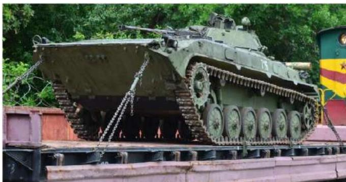
Рисунок 2 – Закрепление гусеничной техники при помощи комплекта УМК-СР
