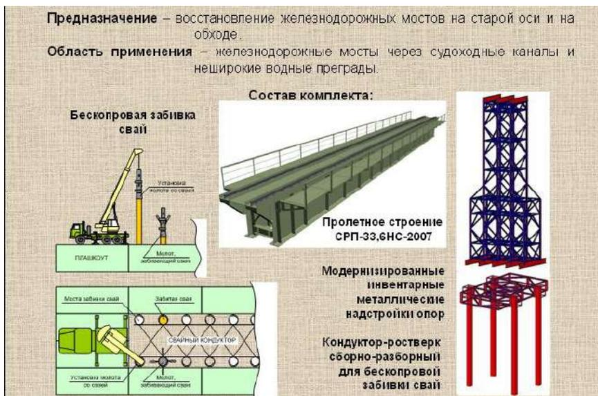
Рисунок 24 – Комплект универсальных мостовых конструкций
