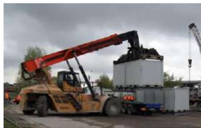
Рисунок 14 – Испытания средств погрузки среднетоннажных модулей
