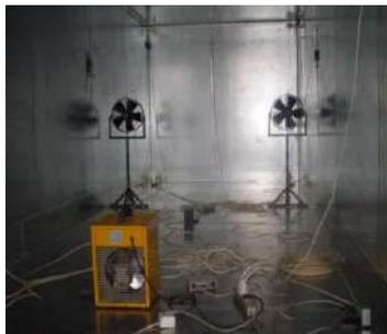
Рисунок 1 – Бокс для проведения теплотехнических испытаний
