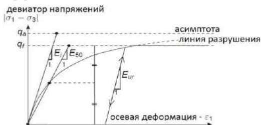
Рисунок 7 – Диаграмма Hardening Soil Model (модель упрочняющегося грунта)
