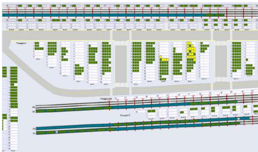
Рисунок 3 – Визуальная модель контейнерной площадки в АС КП, отображаемая приемосдатчику груза и багажа
