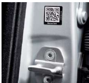
Рисунок 2 – Расположение QR-кода на центральной стойке автомобиля
