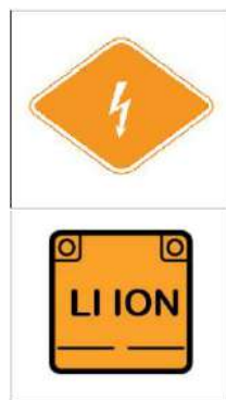
Рисунок 4 – Пиктограммы источников энергии автомобиля TESLA Model S
