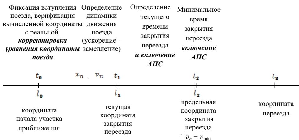
Рисунок 2 – Временные интервалы информационно-управляющей системы управления АПС с корректирующим алгоритмом
