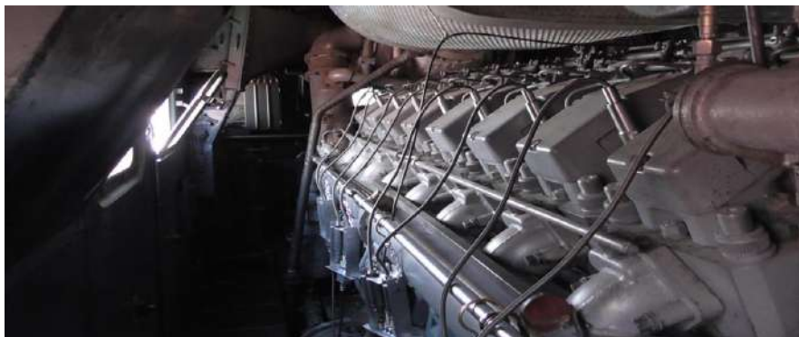
Рисунок 1 – Датчики давления газа ДДГ, установленные на все цилиндры тепловозного дизеля Д49
