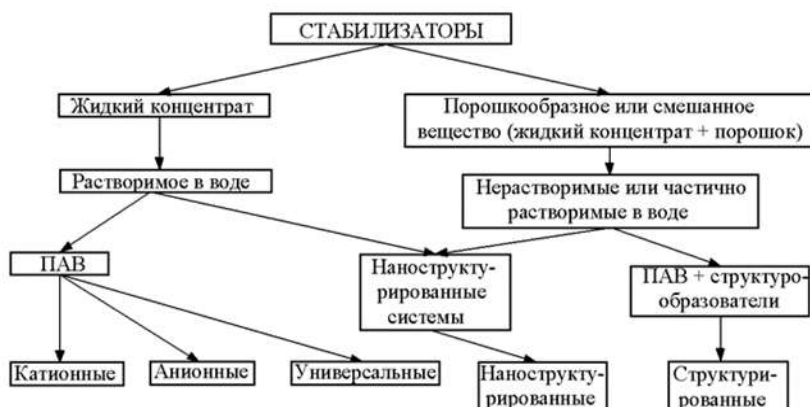
Рисунок 1 – Общая классификация стабилизаторов
