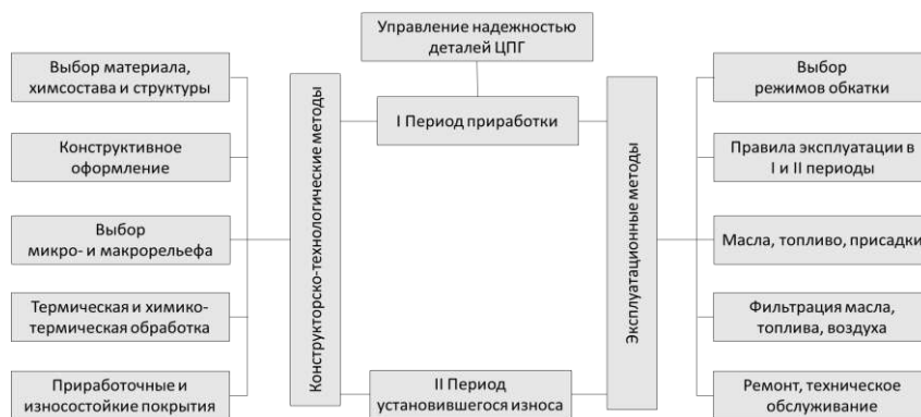
Рисунок 2 – Структурная схема управления надежностью деталей ЦПГ тепловозных дизелей
