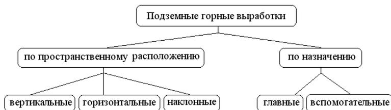
Рисунок 1 – Классификация подземных горных выработок
