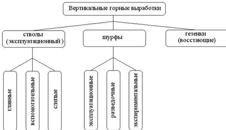
Рисунок 2 – Классификация вертикальных стволов шахт
