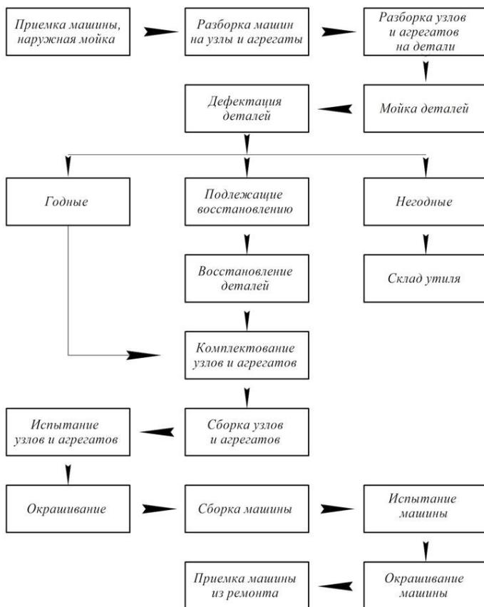
Рисунок 2 – Типичная схема капитального обезличенного ремонта
