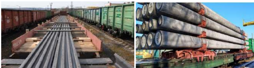
Рисунок 1 – Размещение длинномерных грузов на сцепе вагонов
