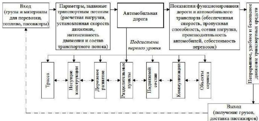
Рисунок 2 – Комплексная модель автомобильной дороги как технико-экономической системы
