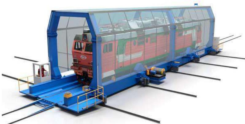
Рисунок 1 – Трансбордер закрытого типа
