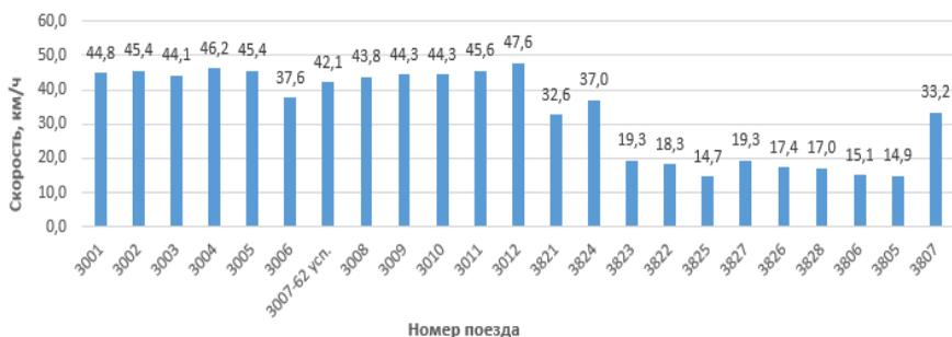
Рисунок 3 – Изменение участковой скорости грузовых поездов на однопутном участке
