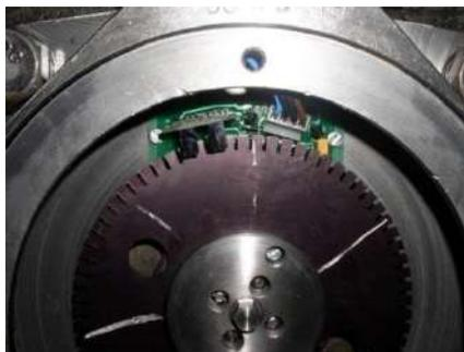
Рисунок 1 – Комплекс процессорного противоюзного устройства с измерителем скорости для четырёхосного вагона «БАРС-4МО» (КППУ-4)
