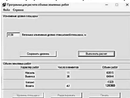
Рисунок 4 – Результаты перерасчета объемов земляных работ
