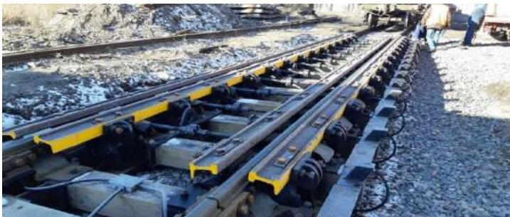
Рисунок 1 – Удерживающее устройство весовое УВУ, установленное на станции Молодечно Белорусской железной дороги для апробации в процессе испытаний
