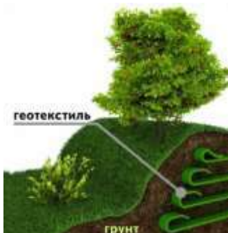
Рисунок 1 – Усиление основания горизонтальным армированием из геотекстиля
