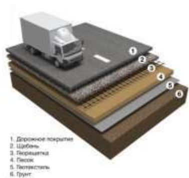
Рисунок 4 – Конструкция земляного полотна насыпи с прослойкой из геосинтетических материалов
