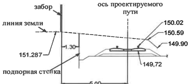
Рисунок 2 – Поперечный профиль с подпорной стеной
