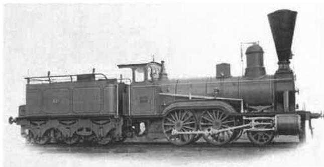
Рисунок 1 – Пассажирский паровоз П.35 № 478 Либаво-Роменской железной дороги, построенный на Коломенском машиностроительном заводе в 1879 г.
