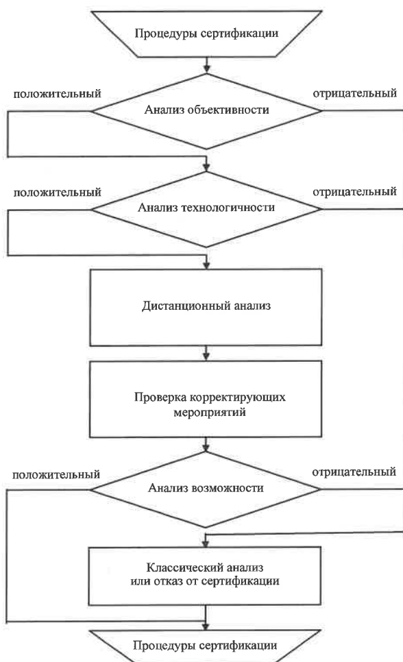
Рисунок 1 – Последовательность проведения работ по анализу состояния производства дистанционным методом
