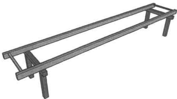
Рисунок 3 – Установленные и приваренные крайние поперечные связи пешеходного настила
