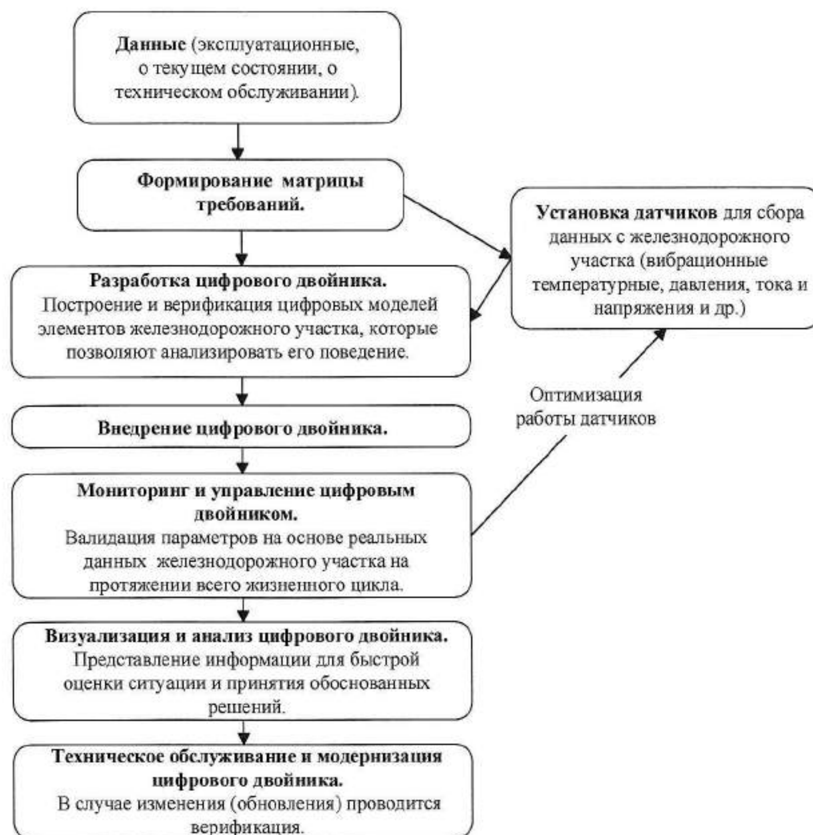
Рисунок 1 – Модель создания и внедрения цифрового двойника железнодорожного участка
