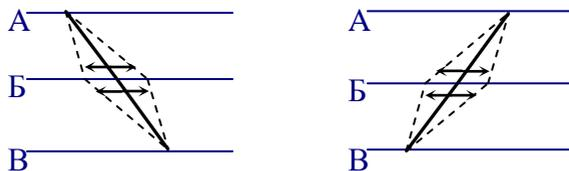
Рисунок 6 – Изменение времени движения по двум прилегающим перегонам
