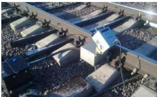
Рисунок 1 – Автоматический прибор для обнаружения нагретых букс
