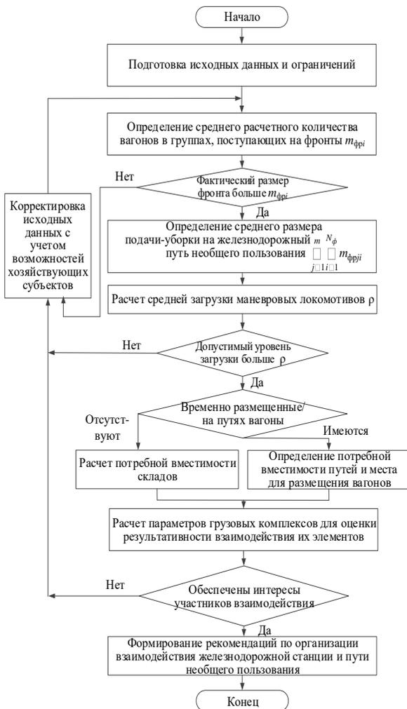
**Рисунок 4 – Алгоритм расчета параметров, характеризующих взаимодействие станций и путей необщего пользования**
