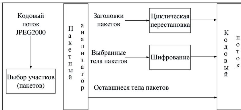
Рисунок 2 – Диаграмма, показывающая процесс селективного шифрования в сочетании с перестановкой заголовков пакетов [3]
