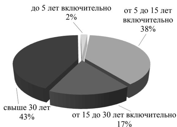
Рис. 2. Структура водопроводных сетей в населенных пунктах Мостовского района по продолжительности эксплуатации
