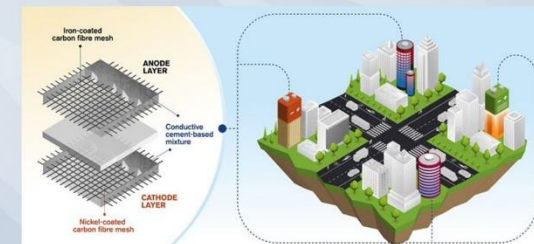
Рис 2. Батареинный блок на основе цемента
