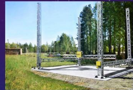
Рисунок 2 - Принтер ICON Vulcan II Размер сборки 2,6 х 8,5 х ∞ м Материал: бетон Страна: США
