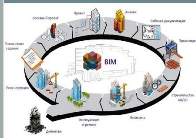
Рисунок 1 - Жизненный цикл строительного объекта в BIM-технологии
