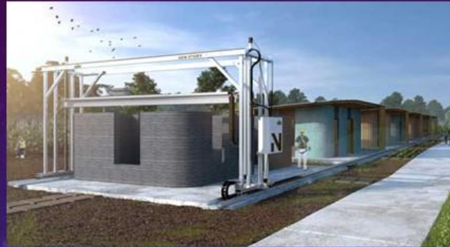
Рисунок 1 - Принтер «АМТ» Размер сборки 3,5х3,6 м (минимум), 11х31х80 (максимум) Материал: бетон, глина, гипс Страна: Россия
