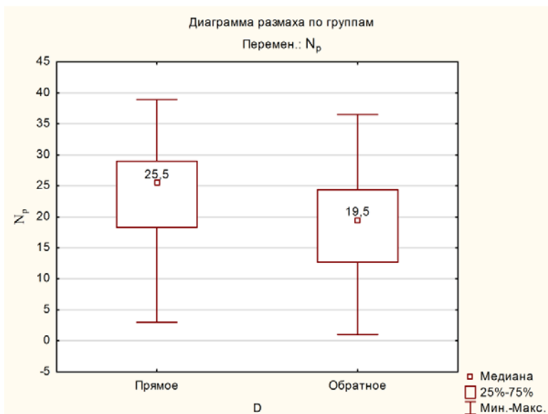
Рисунок 6. – Диаграмма размаха значений средней наполняемости за рейс ( N_p ) на маршруте № 2 в прямом и обратном направлениях
