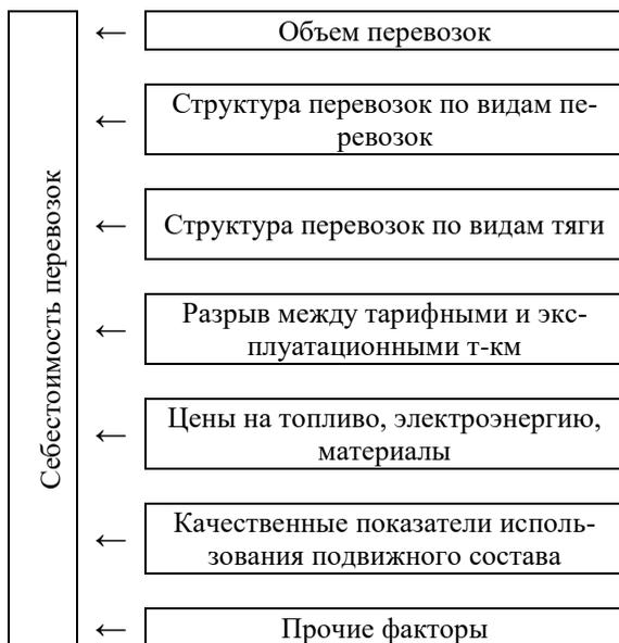
Рисунок 5.4 – Схема факторов, влияющих на себестоимость
