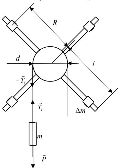
который состоит из четырех стальных спиц длиной  $l$ , скрепленных под прямым углом с легко вращающимся шкивом диаметром  $d$ .
