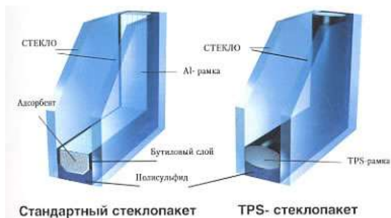
Рисунок 3 - Стандартный и TPS стеклопакеты
