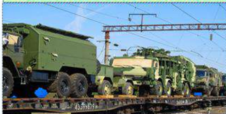
Размещение и закрепление техники на железнодорожном подвижном составе
