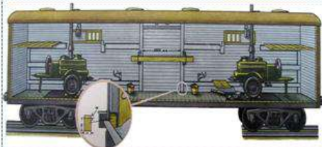
Вагон, оборудованный для перевозки кухонь полевых воинского эшелона
